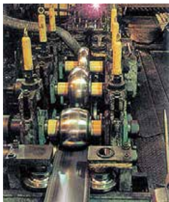
▲造管機(写真右)により製造した溶接ステンレス鋼管 一般配管用(写真左上)・プラント用(写真左下)
