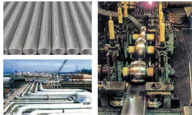
▲造管機(写真右)により製造した溶接ステンレス鋼管一般配管用(写真左上)・プラント用(写真左下)
