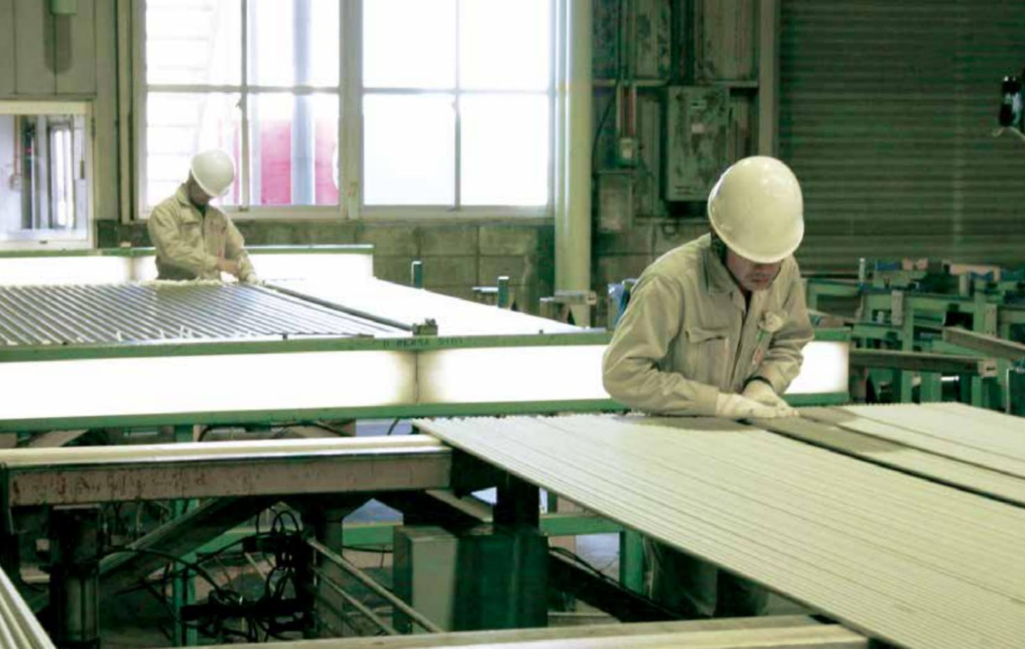
古河市丘里に工場を構え今年で52年となる北関東工場では、大小多岐にわたる製造ラインによって、高品質なステンレス鋼を素材とした幅広いサイズレンジの鋼管を製造しています。中でも高周波誘導加熱+プラズマ溶接法の採用は、製品製造における大きな技術的アドバンテージとなっています。この溶接法は、大河内賞を受賞した独自開発技術です。製品は、プラント・建築物等の配管や水道用配管、食品工業用配管に加え、抽伸設備を活用したシリンドラーなど、多くの分野で幅広く使用されています。これからもステンレス鋼管を通して、より快適で豊かな社会を支えていきます。
