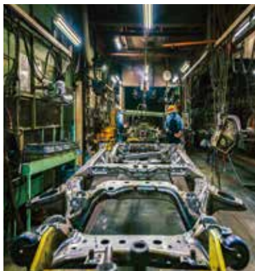
▲シャーシフレームの生産風景(写真左)、トラック以外にもSUVやマイクロバス用の製品も手掛けています(写真右上、右下)
