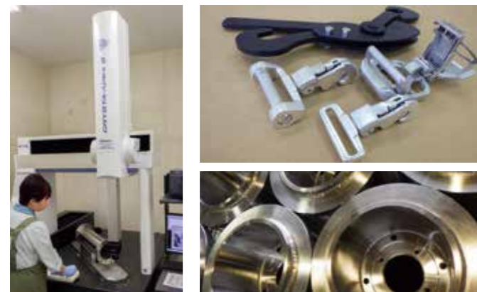
▲三次元測定機による精密な検査(写真左)、パラシュート部品(写真右上)、食品加工ロボット部品(写真右下)
