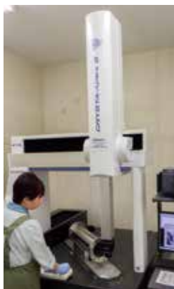
▲三次元測定機による精密な検査(写真左)、パラシュート部品(写真右上)、食品加工ロボット部品(写真右下)
