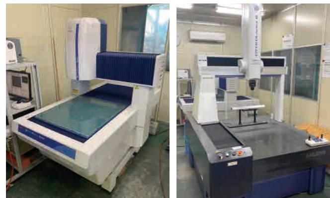
▲画像測定機(左)や三次元測定機(右)を使い、部品の精密検査を実施しています
