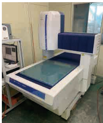
▲画像測定機(左)や三次元測定機(右)を使い、部品の精密検査を実施しています
