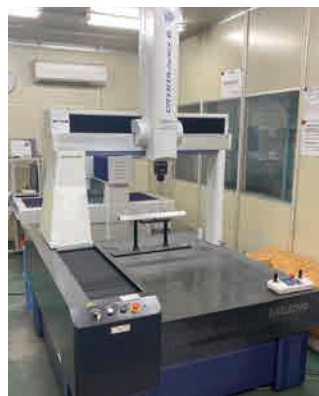
▲画像測定機(左)や三次元測定機(右)を使い、部品の精密検査を実施しています
