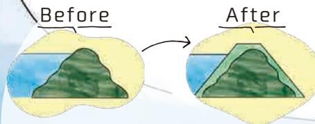
利根川左岸の中田新田地先では、洪水から地域を守るため、堤防のかさ上げと拡幅工事を行っています。
