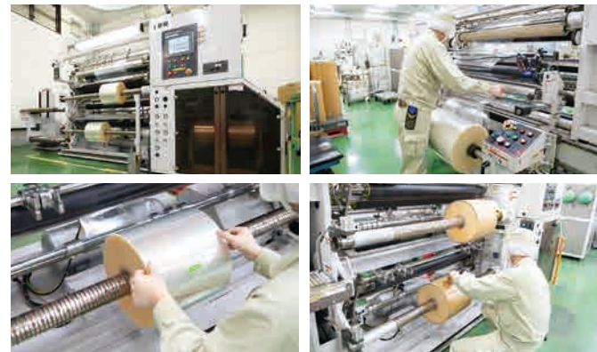
▲フィルムをスリッター設備で裁断するほか、製品の品質検査や包装も行います
