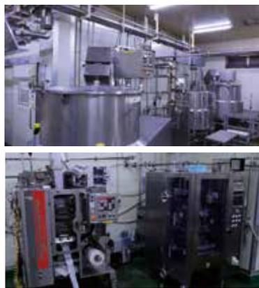
▲製造釜(蒸気釜・直火釜)、計12台(上)と充填機、計8台(下)
