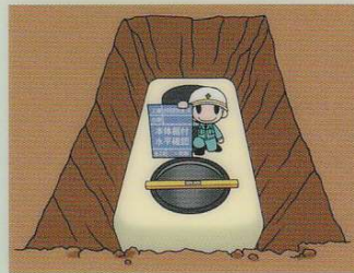
⑩ 本体据付、水平確認
