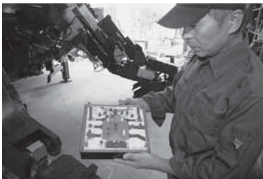
▲この小さな操縦リモコンで、巨大な「カブトムシRX-03」を動かすことができます
