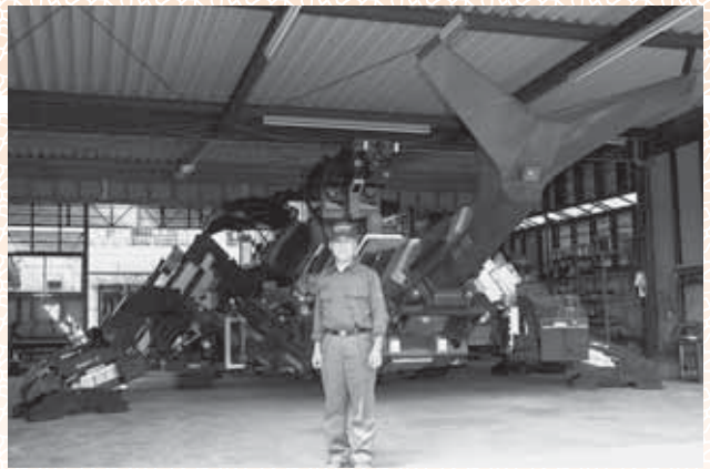
▲油圧制御による完全6足歩行の「カブトムシRX-03」迫力満点です
