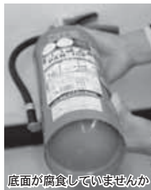
底面が腐食していませんか
