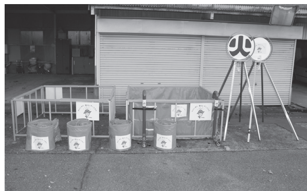
▲組み立て式防火水槽(左)と水槽用給水器(中)、消火訓練用標的(右)
