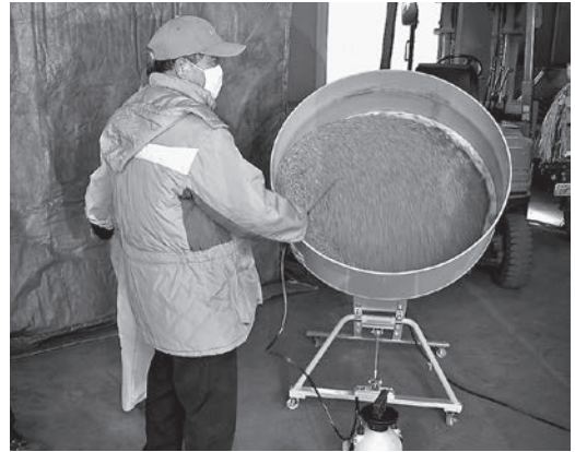
▲ドラム式の機械で鉄粉をコーティング
