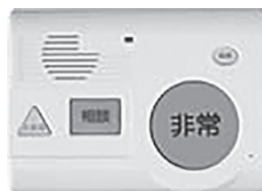
▲緊急通報装置
