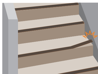
階段の滑り止めの浮き
