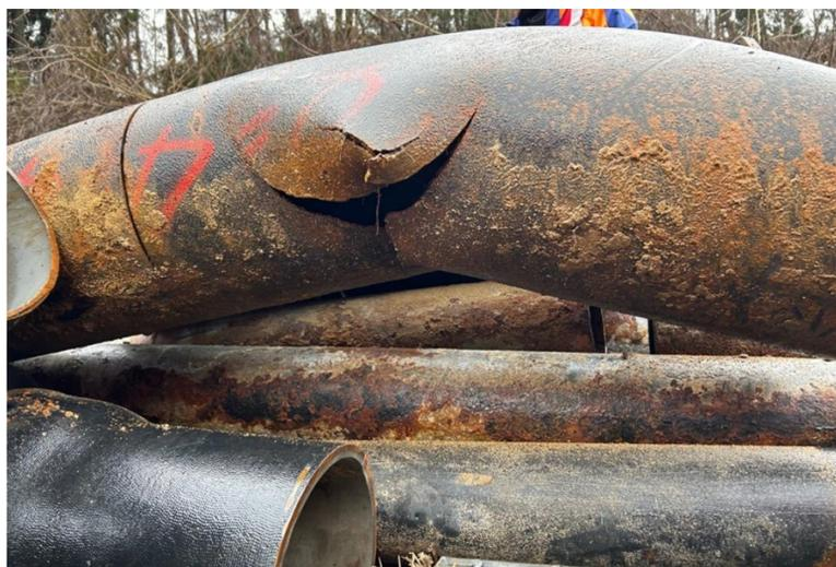
大きく破損した配水管
