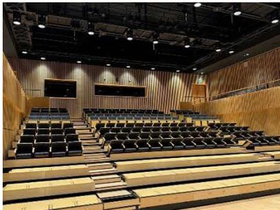
ロールバックチェアの展開は約5分で完了する。全自動で展開されるが、最前面の床との接地面は人力で固定する必要がある。座っていると、他の人が階段を昇降するときに揺れや足音が気になる場合がある。
